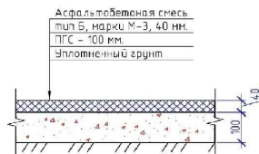
Асфальтобетонное покрытие (Тun 1)
