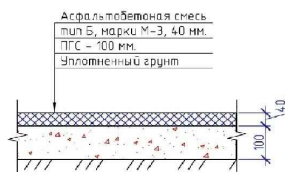
Асфальтобетонное покрытие (Тun 1)
