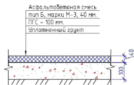
Асфальтобетонное покрытие (Тип 1)
