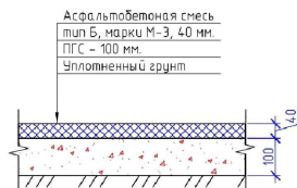
Асфальтобетонное покрытие (Тип 1)
