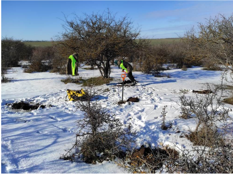
Рисунок 5.2.3 – Отбор объединенной по площади пробы почвы
