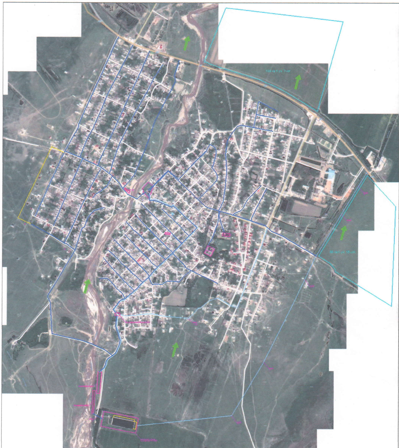
Рис.1.4.5.Схема существующих систем водоснабжения с. Аксай
