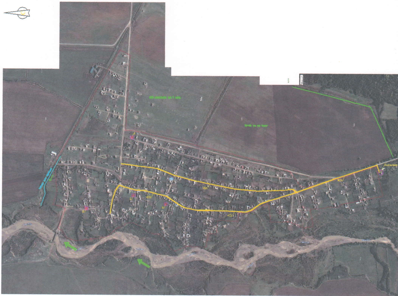
Рис.1.4.5.Схема существующих систем водоснабжения с. Кандаураул
