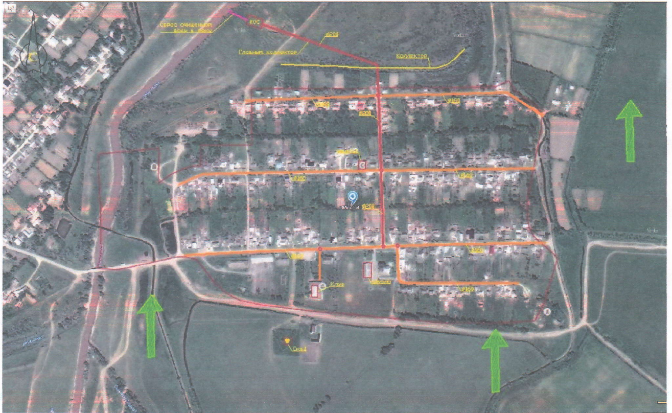
Рис 12.1. Схема водоотведения с. Моксоб на перспективу
